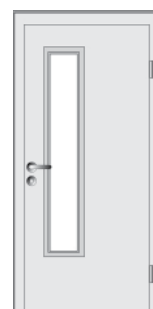
LA 4 Bas : 400 mm Haut et coté serrure : 160 mm Largeur découpe : 200 mm
