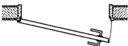
Vue du côté ferrage Ferrage à gauche = DIN Gauche
