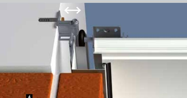
**4** Montage en cas de façade non porteuse (briques ou isolation thermique) avec écoinçon latéral de min. 90 mm à max. 125 mm
